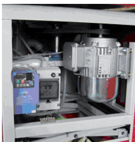
30 721 00 ProVetro Profischleifer Ausstattung mit elektronischer Drehzahlregulierung, Motor CE ProVetro Profi-Beveler equipment
